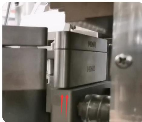
20. Una vez que la placa de vacío comience a elevarse, sostén la leva y asegura nuevamente los tornillos convexos y cóncavos en la leva con una llave Allen.
