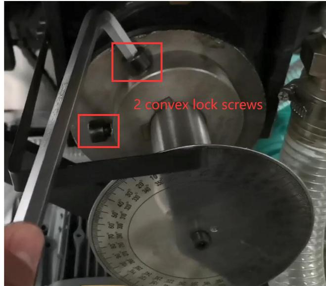
13. Continúa moviendo lentamente la máquina para encontrar los 2 tornillos cóncavos y aflójalos con una llave Allen.
