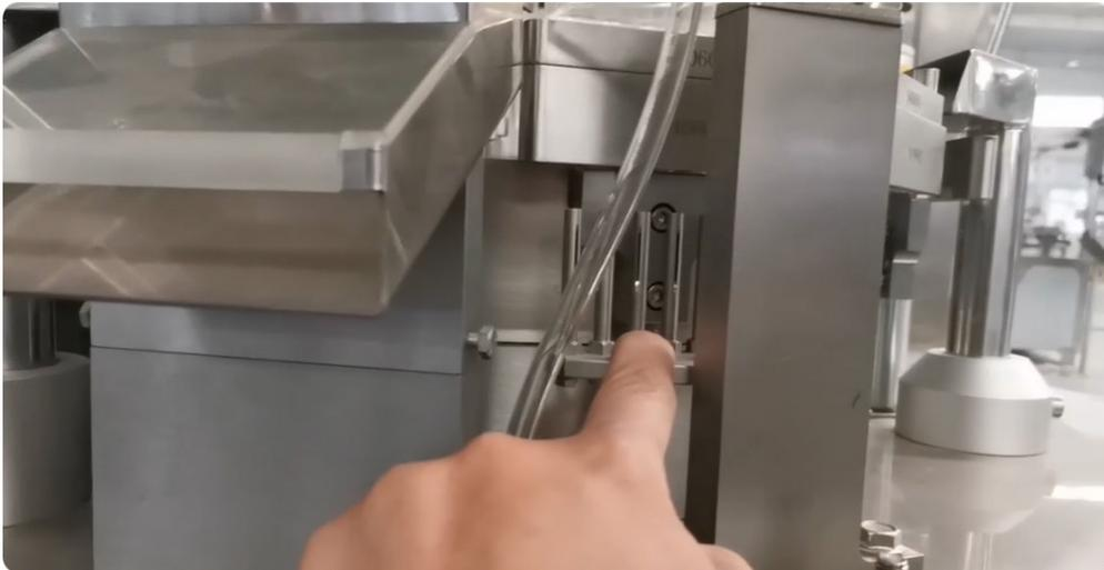
27. Una vez que los Pines de Descarga/Cierre/Rechazo estén en su punto más bajo, sujeta la cámara y vuelve a asegurar los tornillos convexos y cóncavos en la cámara con una llave Allen.
