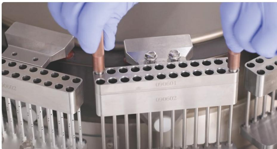
13. Aprieta la nueva sección superior de la herramienta con una llave mientras las herramientas de alineación aún están en su lugar. 13.1 Nota: Aprieta los tornillos lentamente y en pequeños incrementos. Mientras los aprietas, levanta ocasionalmente las herramientas de alineación y gíralas dentro de la nueva herramienta para asegurarte de que estén en la posición correcta.
