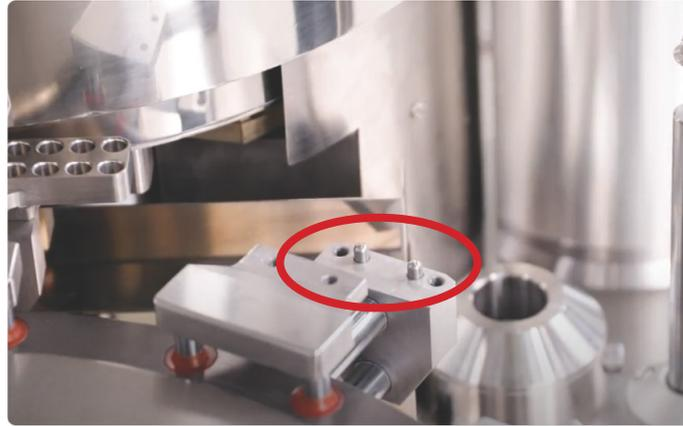
10. Coloca una de las nuevas secciones superiores de la herramienta bajo el borde de la torreta, con el lado biselado hacia arriba, y aprieta sus tornillos suavemente a mano.
