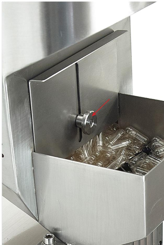
2. Deslice la compuerta hacia arriba y/o abajo para ajustar el flujo de cápsulas.
