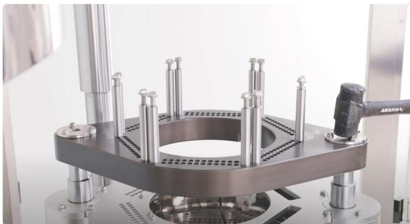
54. Asegura completamente los dos tornillos en la nueva sección central de la Torre de Compactación.
