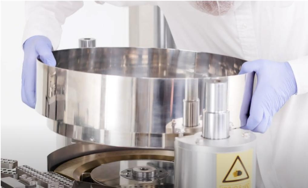
49. Coloca la parte inferior del nuevo Cuenco de Apisonado en la máquina y ajusta los tornillos ligeramente.
