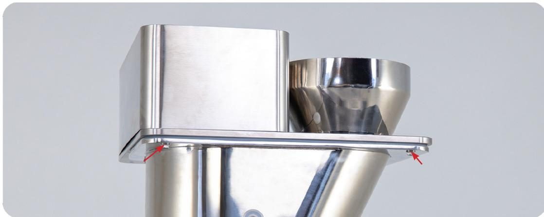
25. Baja el depósito de polvo en la torreta de compactación a través de la cubierta de plástico.
