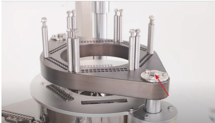
7. Afloja el tornillo del Sensor de Polvo con una llave Allen para quitarlo y dejarlo a un lado.
