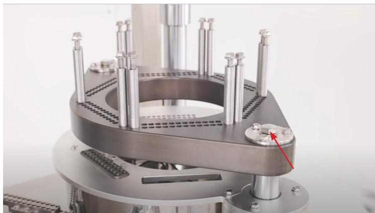
45. Afloja el tornillo del sensor de polvo con una llave Allen para quitarlo y déjalo a un lado.
