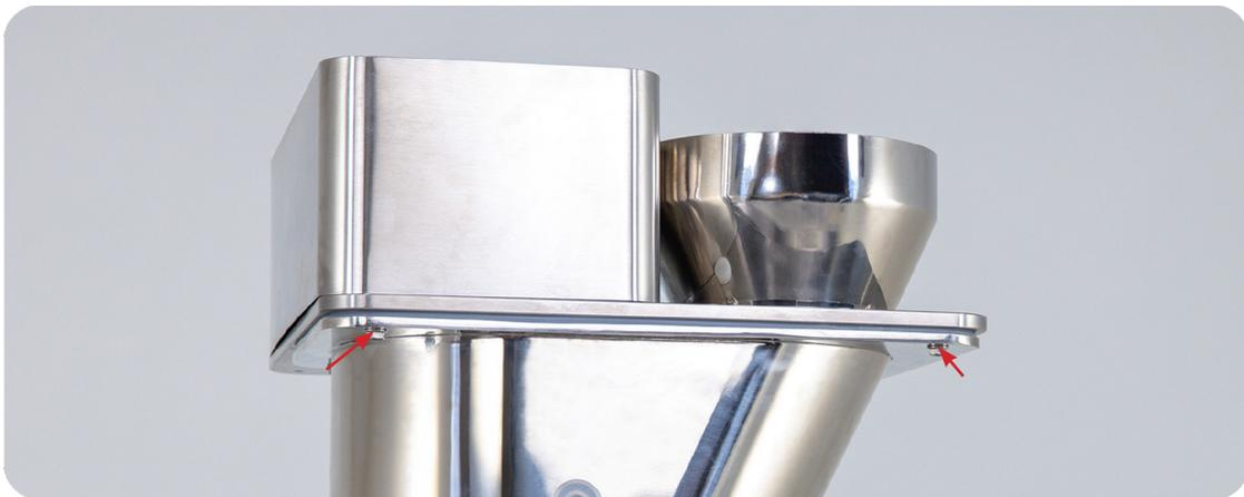
70. Baja el depósito de polvo en la torreta de compactación a través de la cubierta de plástico.
