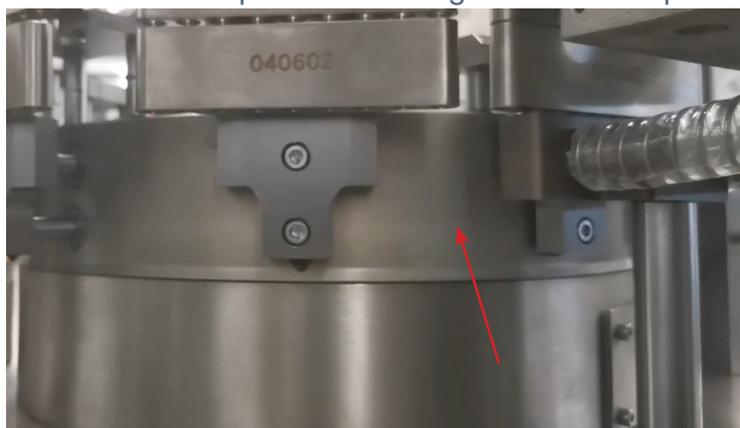
4. Verifica el indicador de posición para asegurarte de que la torreta del segmento de troquel esté a 360/360 grados. 4.1 Nota: Si no está en esta posición, retira el perno en el centro del indicador de posición con una llave Allen. Ajusta el indicador de posición hasta que esté en el grado correcto y aprieta su tornillo con una llave Allen.
