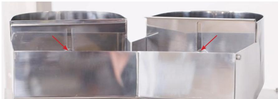
18. Retira los dispensadores de cápsulas aflojando sus tornillos con una llave Allen.
