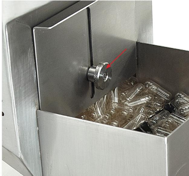
2. Desmonta los contenedores de cápsulas aflojando sus tornillos con una llave Allen.
