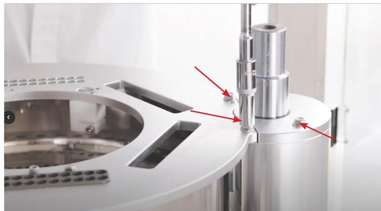
7. Afloja los seis tornillos que sujetan el Disco Dosificador y limpia cualquier exceso de polvo entre el Disco y el anillo de sellado.
